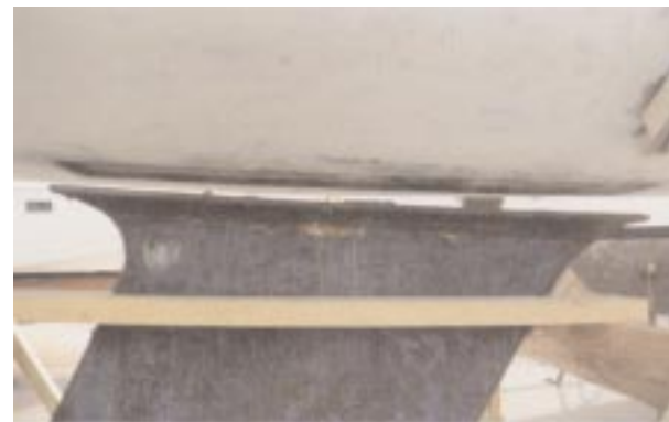
Um den kritischen Kiel-Rumpf-Bereich zu prüfen, wurde hier der Kiel demontiert
