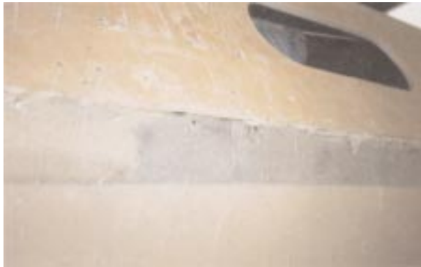
Durch die vielen Bohrlöcher ist Feuchtigkeit ins Laminat gedrungen
