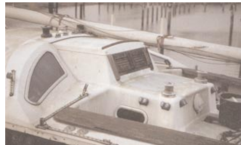
Der Aufbau wimmelt von Decksdurchbrüchen und Beschlägen mit Bohrlöchern, die alle saniert werden müssen, weil Feuchtigkeit ins Laminat gedrungen ist
