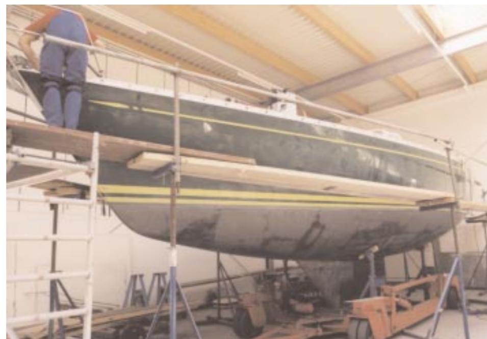
Im Laufe der Jahre war die Außenhaut der Swan 46 ausgebleicht und unansehnlich geworden (1.) Über- und Unterwasserschiff werden gründlich gereinigt (o.). Dann folgt der erste Anstrich (ganz o.).
