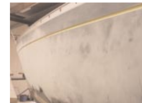
Der Rumpf ist einmal gründlich durchgeschliffen, der alte Lack nicht wiederzuerkennen (r). sorgfältige Kontrolle der Außenhaut auf Riefen und Löcher sowie Spachteln, nachdem der erste Voranstrich mit der Spritzpistole erfolgt ist (beide Photos M.). Präzise wird der Übergang zum Deck mit einem gegen Lösemittel unempfindlichen Lackklebeband abgeklebt (u.).
