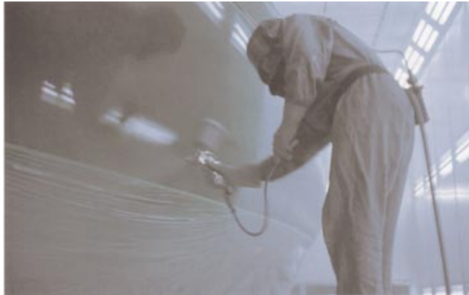
Nach dem Spachteln, einer weiteren Voranstrichschicht und Schleifen, wird die erste Lackschicht Interspray 900 aufgespritzt (o.). Neuer Glanz für alten Namen – die Aufklebung hat funktioniert (r.). Perfekter Lackauftrag – die Spiegelung der Lampen im Lack macht es deutlich (u.).
