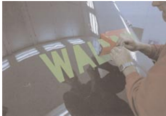
Nach dem Spachteln, einer weiteren Voranstrichschicht und Schleifen, wird die erste Lackschicht Interspray 900 aufgespritzt (o.). Neuer Glanz für alten Namen – die Aufklebung hat funktioniert (r.). Perfekter Lackauftrag – die Spiegelung der Lampen im Lack macht es deutlich (u.).
